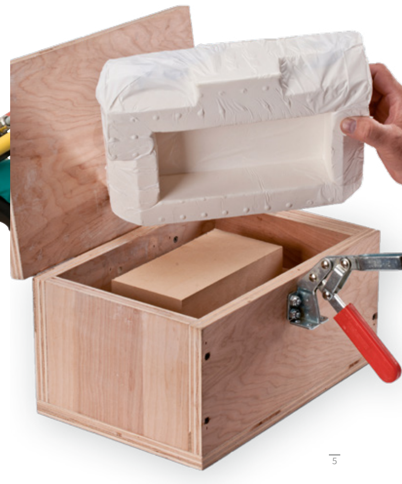
Formowanie wstępne FOAMplus®
