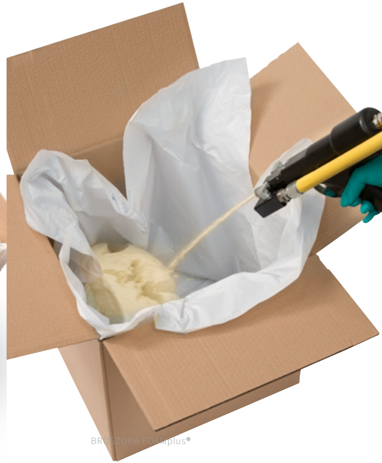
Wtrysk bezpośredni FOAMplus®
